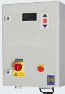
AS 500 FU E Ovládanie s frekvenčným meničom v oceľovej skrini IP 54 trojfázové, 400 V
