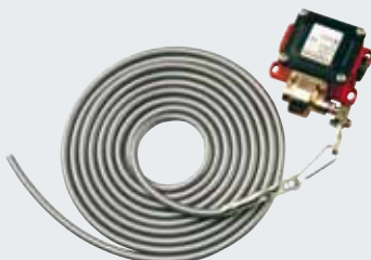
Ťahový spínač s ťažným lanom z plastu s možnosťou vodorovnej alebo zvislej montáže, teleso z tlakového hliníkového odliatku, IP 65, dĺžka lana 4 m
