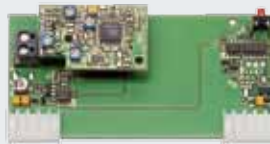
Prijímač HER 1 (1-kanálový) s bezpotenciálovým reléovým výstupom, v samostatnom kryte bez prípojného vedenia alebo ako zasúvací karta v riadiacej skrini.
